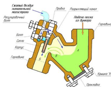
Рисунок 2 – Форсунка песочницы ФПЗ-64 электровоза 2ЭС6
