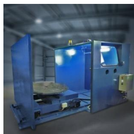
Рисунок 2 – Автоматическая камера для обдувки тяговых электродвигателей
