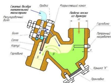
Рисунок 3 – Форсунка песочницы ФПЗ-64 электровоза 2ЭС6 с патронным нагревателем в корпусе
