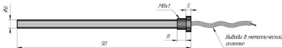
Рисунок 4 – Внешний вид патронного нагревателя ЭПВ6х50 для монтажа в корпус форсунки песочницы
