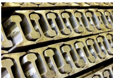
Рисунок 1 – Категория рельсов ДТ370 (вязко-прочные)
