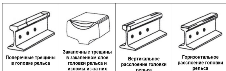
Рисунок 1 – Примеры дефектов рельсов
